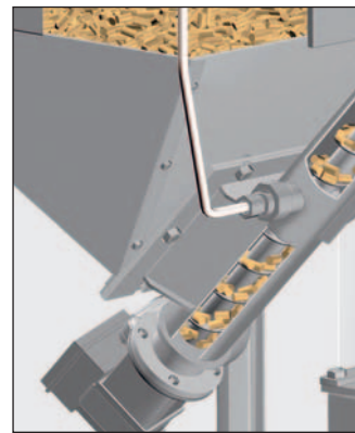
Taktend geregelte Dosierschnecke
